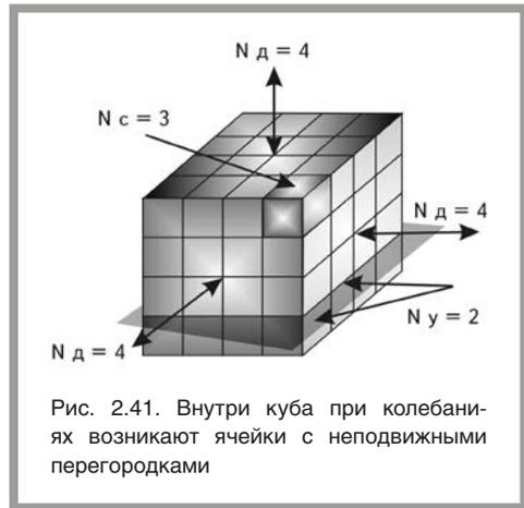
Рис. 2.41. Внутри куба при колебаниях возникают ячейки с неподвижными перегородками
