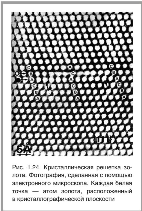
Рис. 1.24. Кристаллическая решетка золота. Фотография, сделанная с помощью электронного микроскопа. Каждая белая точка — атом золота, расположенный в кристаллографической плоскости
