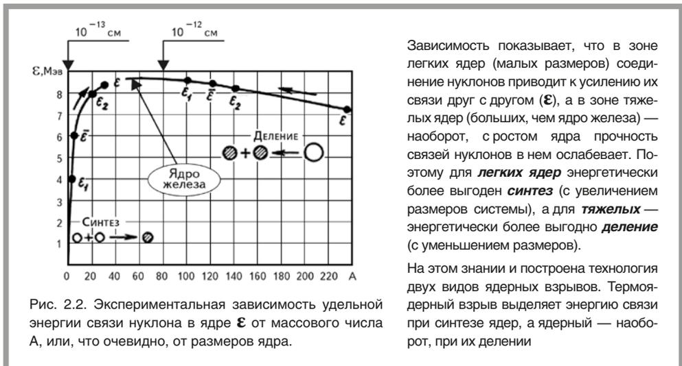
Зависимость показывает, что в зоне легких ядер (малых размеров) соединение нуклонов приводит к усилению их связи друг с другом ( $\epsilon$ ), а в зоне тяжелых ядер (больших, чем ядро железа) — наоборот, с ростом ядра прочность связей нуклонов в нем ослабевает. Поэтому для **легких ядер** энергетически более выгоден **синтез** (с увеличением размеров системы), а для **тяжелых** — энергетически более выгодно **деление** (с уменьшением размеров).
