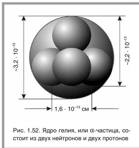
Рис. 1.52. Ядро гелия, или  $\alpha$ -частица, состоит из двух нейтронов и двух протонов
